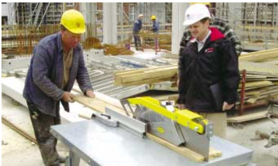
Mit der Avola-Schutzhaube, befestigt am Spaltkeil, lassen sich größere Schalenteile gefahrlos durchtrennen
