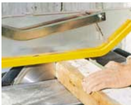
Die Suva-Schutzhaube B90 senkt sich bis auf das Werkstück ab
