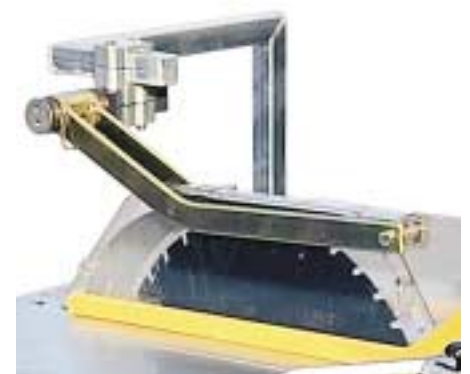
Seitliche Befestigung der Suva-Schutzhaube am Säge Tisch
