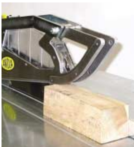
Die Avola-Sicherheitsschutzhaube SSH passt sich optimal an das Werkstück an
