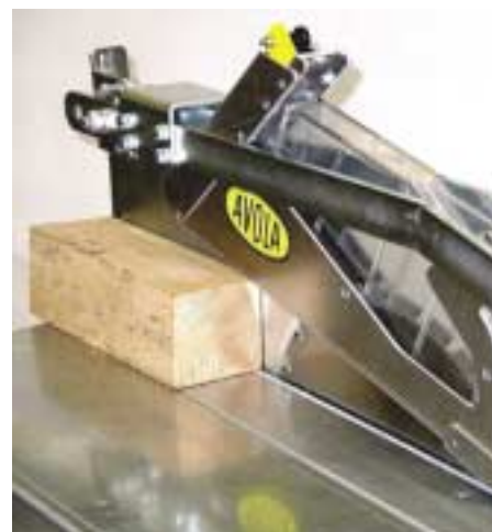
Die Avola-Sicherheitsschutzhaube SSH passt sich optimal an das Werkstück an
