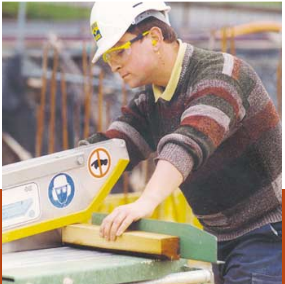
Sicheres Sägen mit der Suva-Schutzhaube B90
