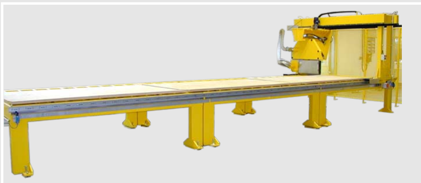
STS/T SK – Brückensäge für Trockenschnitt, schwenkbar, mit langem Tisch, in modularer Bauweise beliebig verlängerbar, mit Positioniersteuerung
