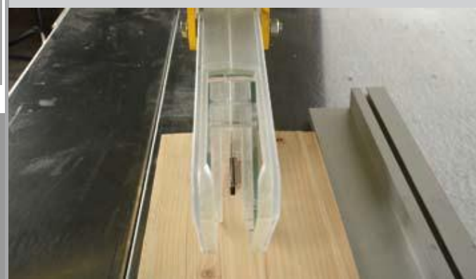
Butée parallèle en aluminium à réglotte plate Vue améliorée sur la procédure de coupe grâce au nouveau modèle de cape de sécurité
