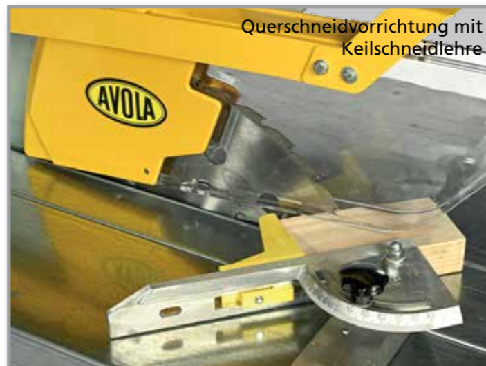
Querschneidvorrichtung für Ablängschnitt 90°-45°
